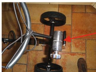
Auf dem doppelt gefalteten Rohr befindet sich ein Knopf. Lösen Sie es gut und schieben Sie das Druckrohr zuerst auf. Bewegen Sie sich seitwärts und dann nach oben, bis es auf die trifft. Die richtige Höhe ist angenehm und der Knopf wieder festziehen. Am Anfang geht das etwas steif, besonders nach dem Lösen. Ziehen Sie die 2 Komponenten (siehe Pfeil) auseinander.
